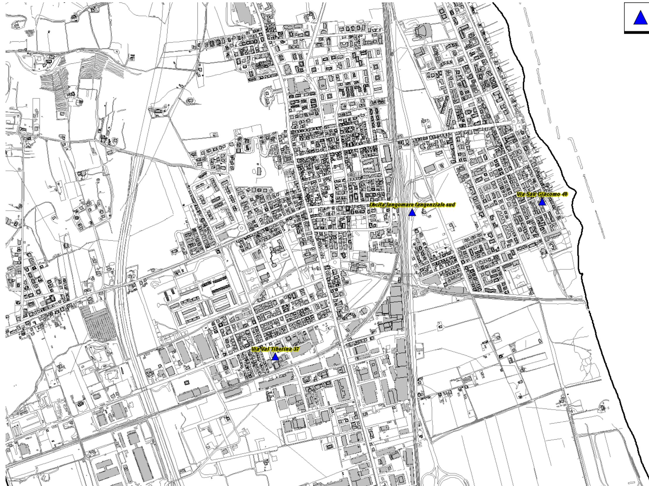
Fig. 16 Dettaglio Impianti Attivi Gestore H3G – San Benedetto del Tronto Sud
