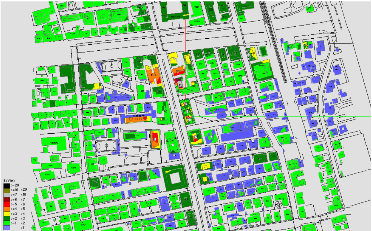
Fig. 82 Impatto elettromagnetico – zona Via De Gasperi – vista dall'alto
