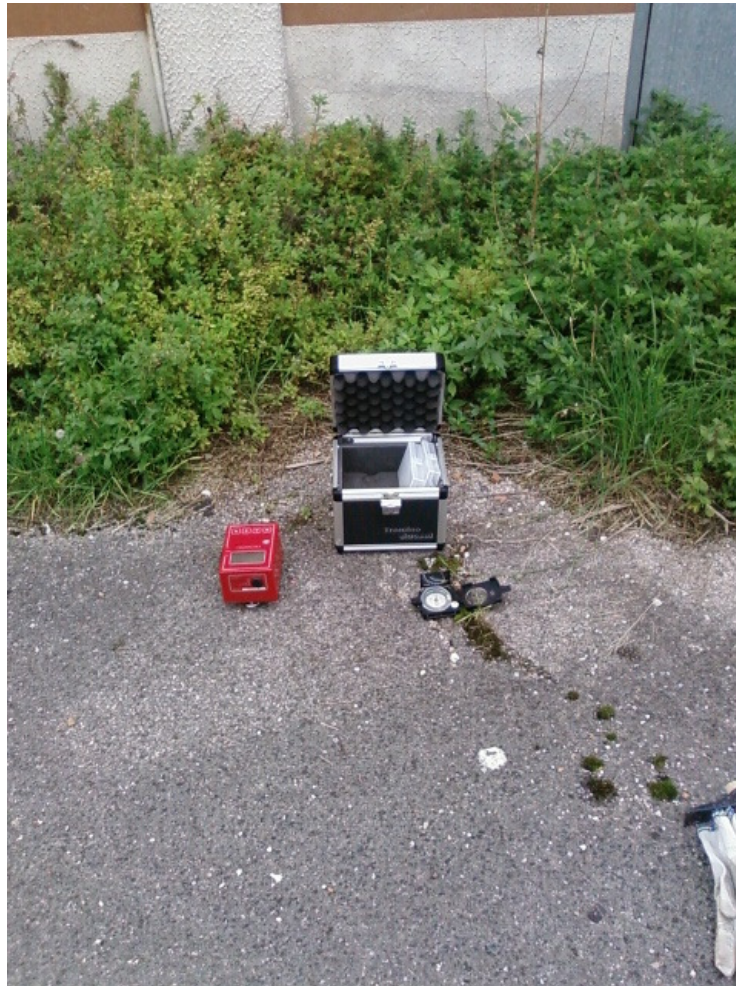
Registrazione tremori ambientali tramite Tromino
