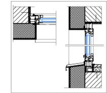
PARTICOLARE e : PIANTE E SEZIONE INFISSI SCALA 1:10
