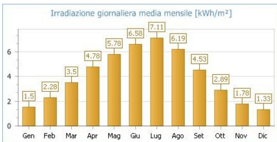
Fig. 1: Irradiazione giornaliera media mensile sul piano orizzontale [kWh/m 2 ]- Fonte dati: UNI 10349 - Località di riferimento: ASCOLI PICENO (AP)/TERAMO (TE)
